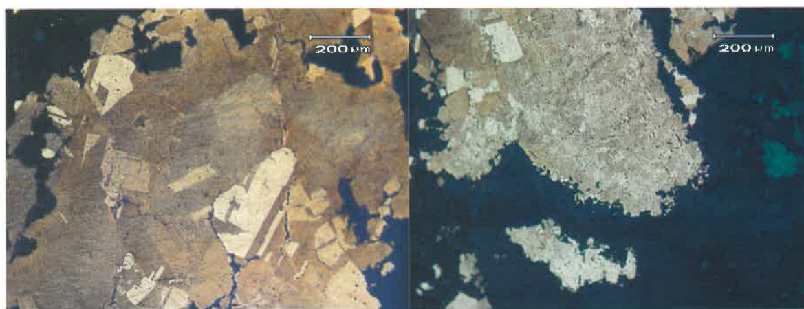
Fig. 65. M-8914. Izquierda: microestructura del sector medio del vástago. Se puede ver una estructura de granos poligonales con maclas de recocido rectas. Derecha: detalle de microestructura con restos de la estructura vaciada.
