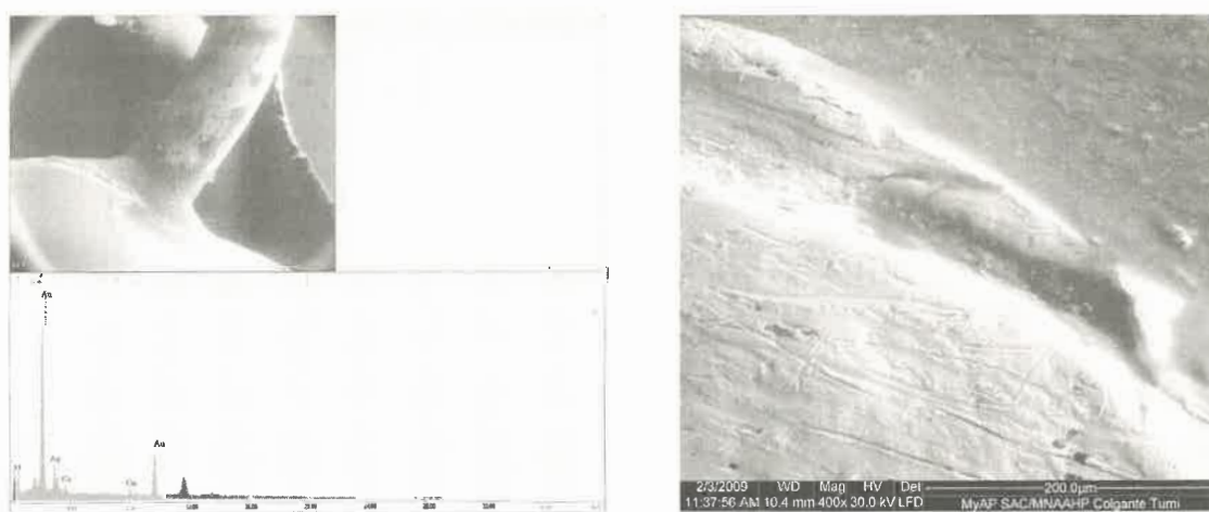
Figura 43: resultado de análisis de soldadura por SEM.
